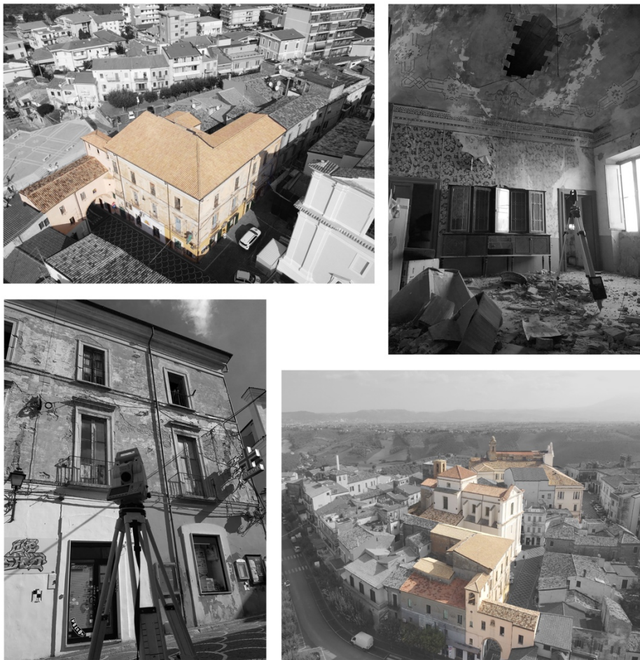
Fig. 07. Rilievo laser scanner ed utilizzo del drone, (elaborato di Raffaella Di Gregorio e studio C.A.Sa.).
